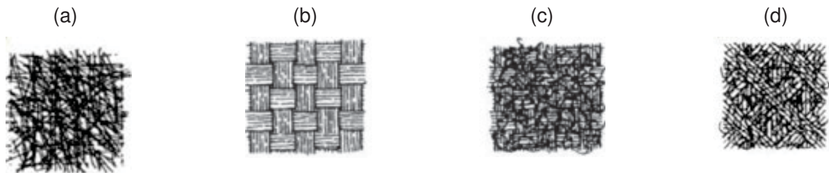
FIGURA 3 – TIPOS DE MANTAS DE FIBRA: (a) DISPOSTAS ALEATORIAMENTE, (b) TECELAGEM BIDIRECIONAL 0/90, (c) TECELAGEM BIDIRECIONAL E FIBRAS DISPOSTAS ALEATORIAMENTE E (d) FIBRAS ALINHADAS 0/90/ \pm 45 E DISPOSTAS ALEATORIAMENTE
