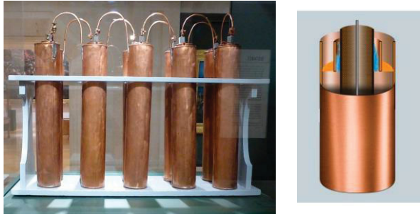
FIGURA 2 – A Pilha de Daniell – Baterias Constante
