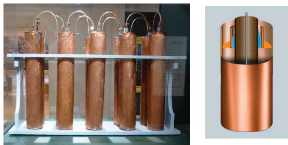
FIGURA 2 – A Pilha de Daniell – Baterias Constante
