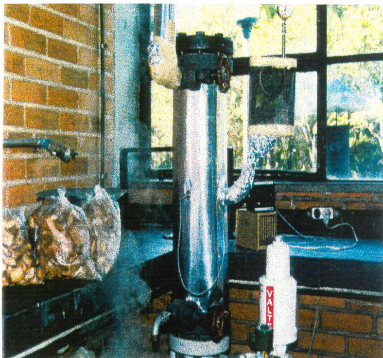
FIGURA 10: Reator de pré-tratamento de materiais lignocelulósicos por explosão a vapor.
