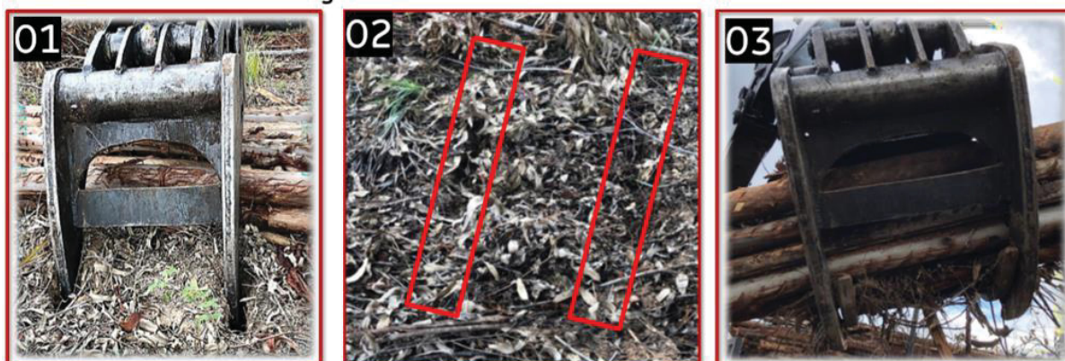
Figura 9: Garra sem mandíbula no transporte de resíduos
