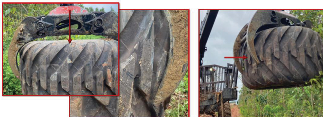
Figura 15: Técnica de movimento de pneus.
