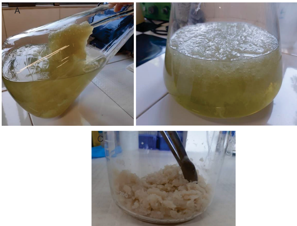
Figura 9: Precipitação etanólica do material submetido à extração com ácido nítrico ( \text{HNO}_3 ) (A e B) e após filtração do material (C).
