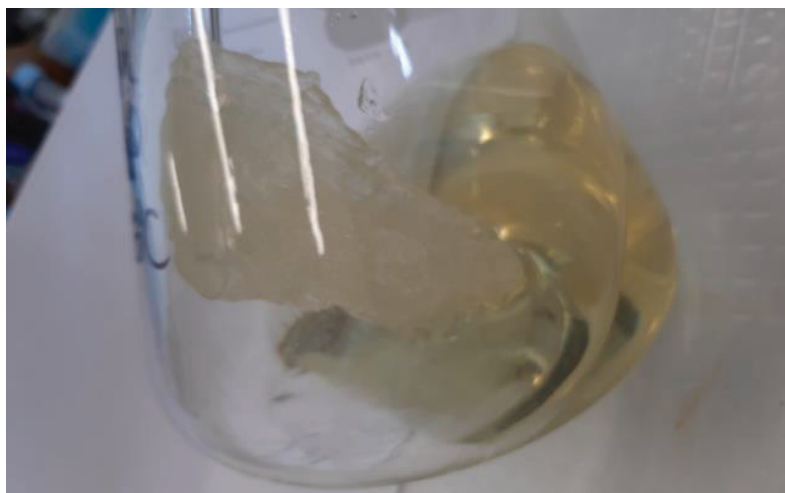
Figura 8: Precipitado etanólico da extração aquosa 90 °C da casca correspondente à fração CW90 Fonte: A autora (2020)
