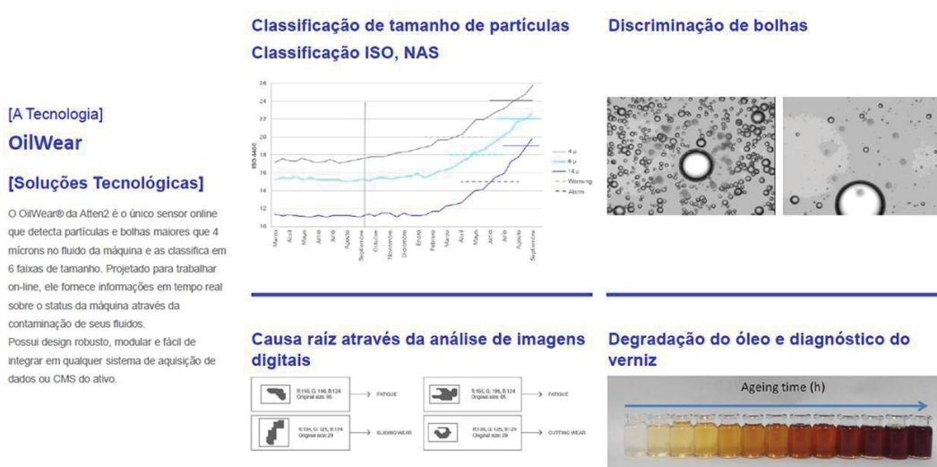
Figura 8. Classificação do tamanho de partículas, discriminação de bolhas e causa-raiz (morfologia de partículas) (análise preditiva de óleo) e testes visuais para degradação de óleo (análise de inspeção de óleo).
