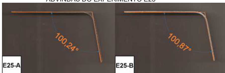
FIGURA 70 – ÂNGULOS MEDIDOS APÓS RETORNO ELÁSTICO PARA AS AMOSTRAS ADVINDAS DO EXPERIMENTO E25
