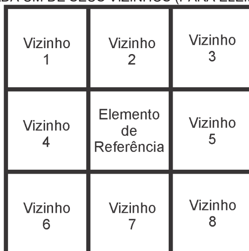
FIGURA 37 – REPRESENTAÇÃO SIMPLIFICADA DA RELAÇÃO ENTRE CADA ELEMENTO DA MALHA COM CADA UM DE SEUS VIZINHOS (PARA ELEMENTO INTERNO)
