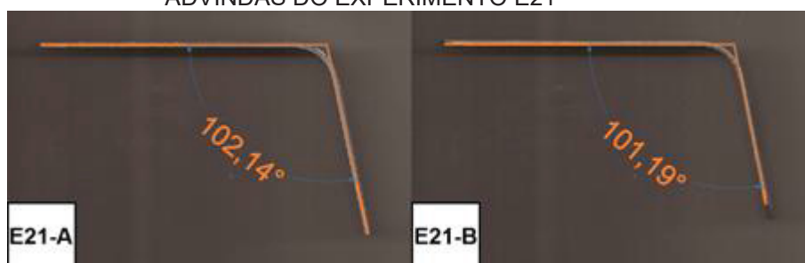
FIGURA 68 – ÂNGULOS MEDIDOS APÓS RETORNO ELÁSTICO PARA AS AMOSTRAS ADVINDAS DO EXPERIMENTO E21
