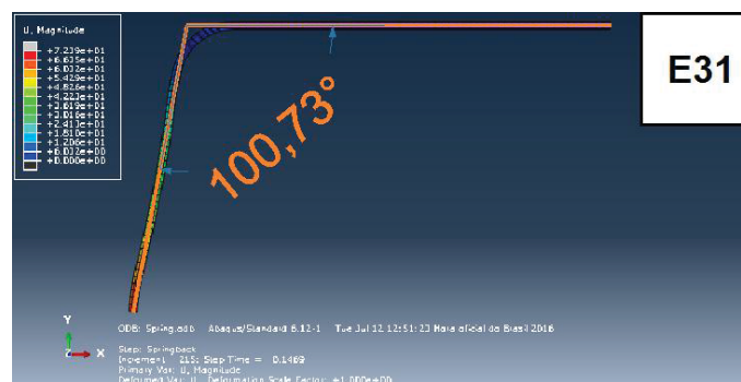
FIGURA 90 – ÂNGULO MEDIDO APÓS RETORNO ELÁSTICO PARA A SIMULAÇÃO COMPUTACIONAL E31
