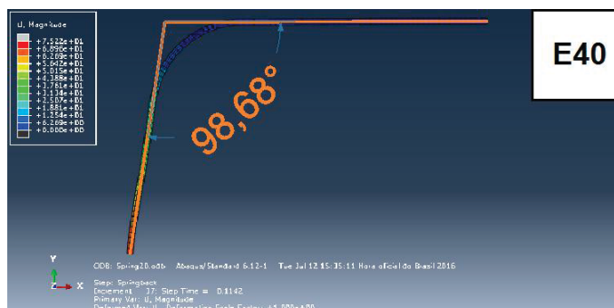
FIGURA 95 – ÂNGULO MEDIDO APÓS RETORNO ELÁSTICO PARA A SIMULAÇÃO COMPUTACIONAL E40
