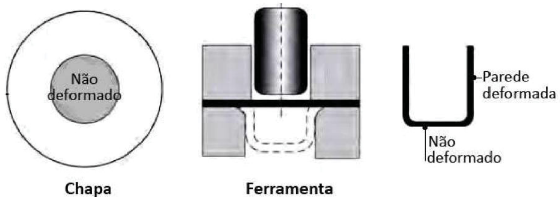
FIGURA 4 - PLANIFICADO CIRCULAR CONFORMADO EM COPO CILÍNDRICO POR MEIO DE EMBUTIMENTO PROFUNDO
