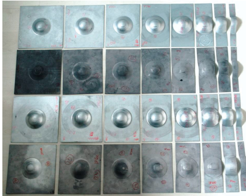
FIGURA 33 – CONJUNTO DE CORPOS DE PROVAS GERADOS PARA LEVANTAMENTO EXPERIMENTAL DAS CLC
