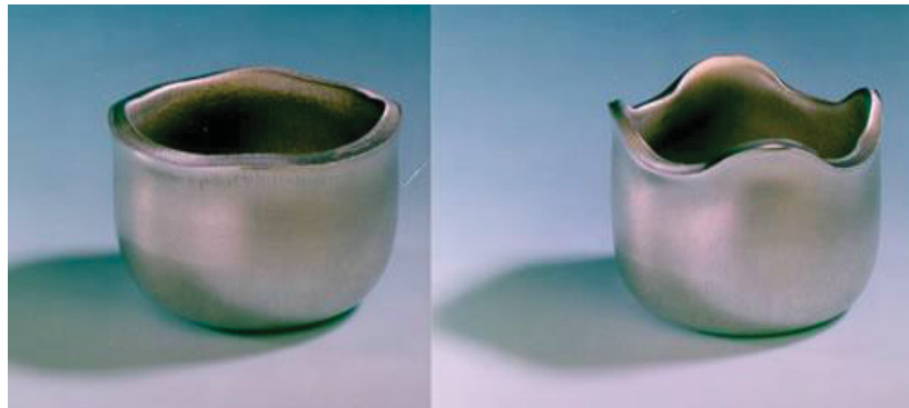
FIGURA 11 – EXEMPLOS DO EFEITO DE ORELHAMENTO EM COPOS EMBUTIDOS DE LIGAS DE ALUMÍNIO
