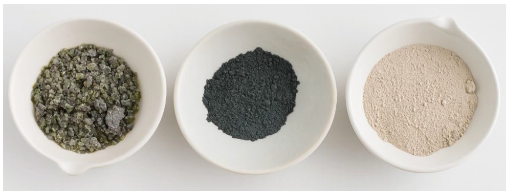
Figura 27: Materiais empregados. (A) Escória, (b) Cinza da casca de arroz, (c) Caulim
