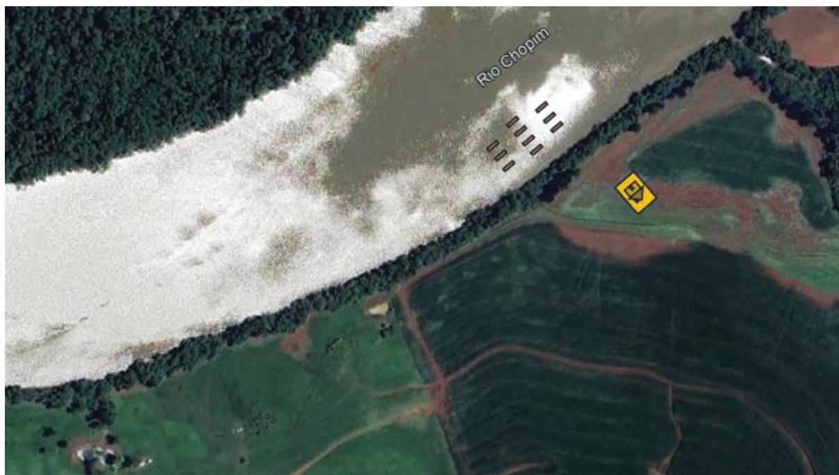
FIGURA 20 - REPRESENTAÇÃO DE 10 TURBINAS STREAMDIVER® INSTALADAS E CASA DE COMANDO E CONTROLE
