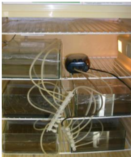
Figura 8: Bioensaio subcrônico: Aquários de vidro cobertos com plástico filme e bomba de aeração.
