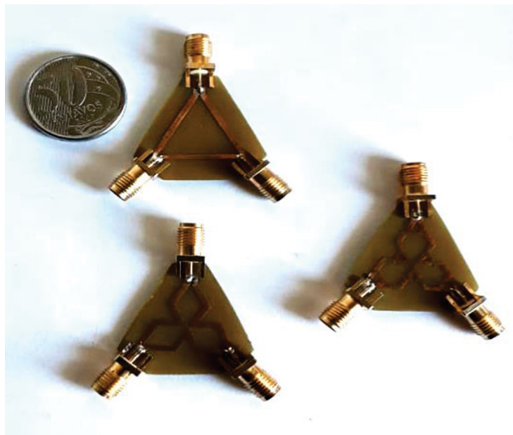
FIGURA 14: PROTÓTIPOS DE DIVISORES DE POTÊNCIA EM FORMA DE T COM GEOMETRIA FRACTAL DE ORDEM 0,1 E 2.
