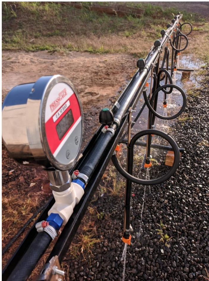
FIGURA 6 – Barra de aplicação da bancada experimental.
