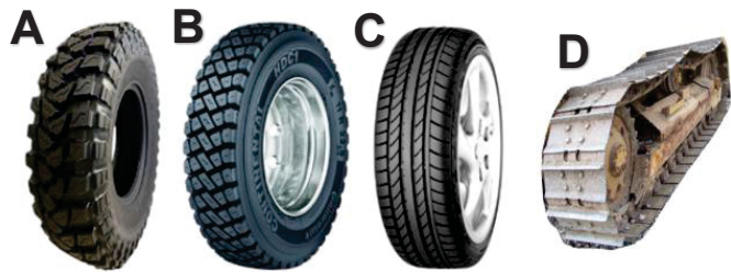
FIGURA 3.28 – REPRESENTAÇÃO DOS PNEUS MT (A), AT (B), HT (C) E LAGARTAS (D).
