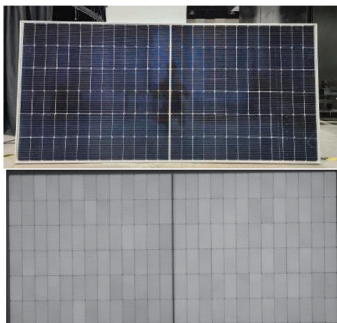
FIGURA 8 – EXEMPLO DE UM ENSAIO DE ELETROLUMINESCÊNCIA
