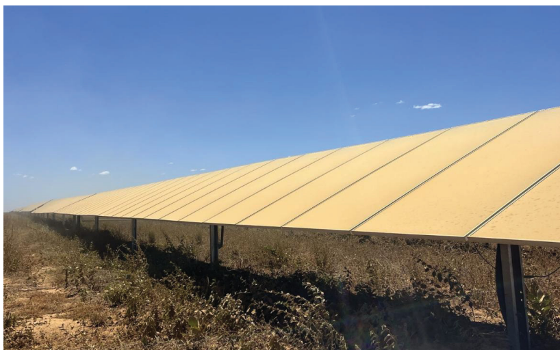
FIGURA 4 – EXEMPLO DE SUJIDADE DO MÓDULO FV
