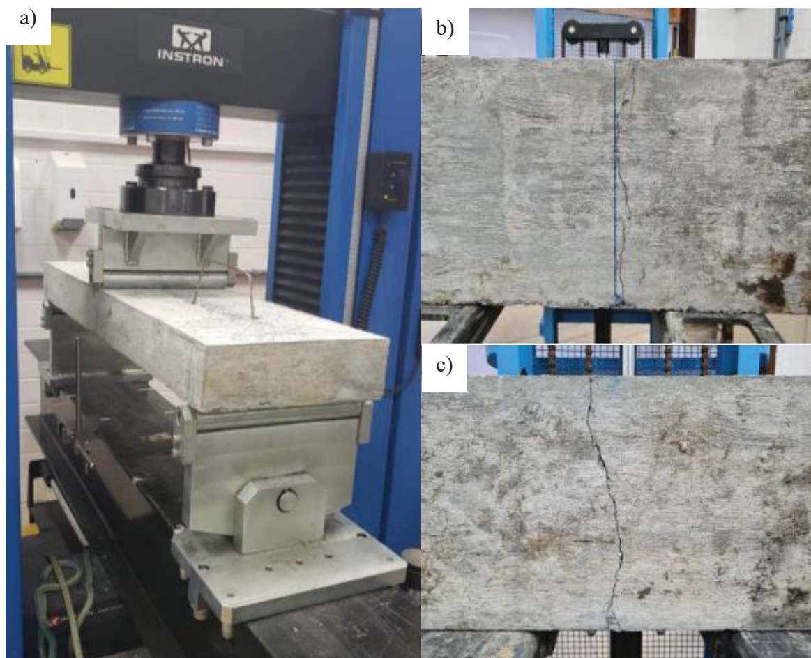
FIGURA 56 - Registros fotográficos da condição final do elemento a) antes, b e c) depois do ensaio
