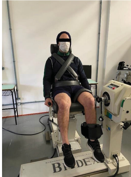
Figura 13. Posicionamento do sujeito para realização da CIVM do extensor do joelho direito no Dinamômetro isocinético Biodex Medical System , EUA
