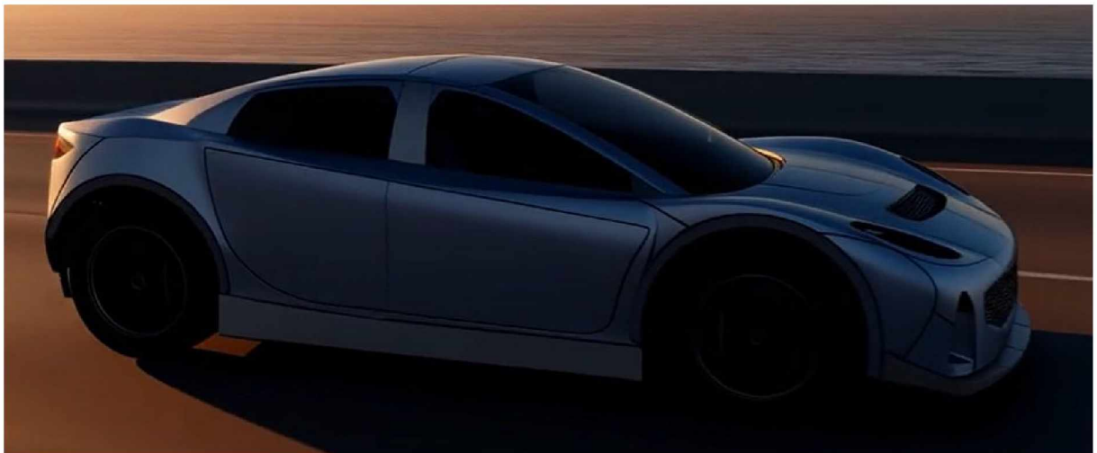
Fig 6 – Renderização do Veículo DeCarbon mostrando o perfil arqueado do teto e das laterais, a ausência dos retrovisores (substituídos por câmeras) e o scoop do capô que faz a extração de ar quente do radiador.
