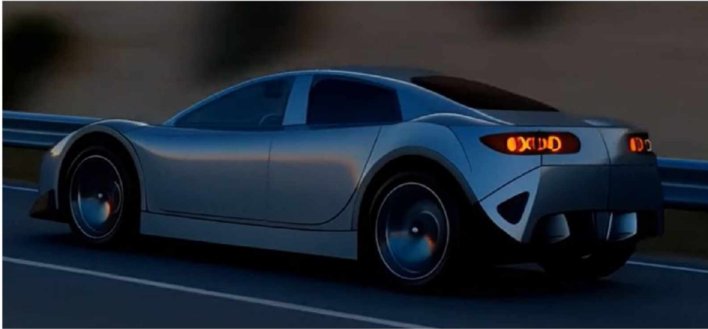
Fig 10 – Renderização 3D do Veículo DeCarbon mostrando as soluções aerodinâmicas aplicadas, como o teto em formato de arco, o perfil baixo, o para-brisas inclinado, as superfícies laterais fluidas e o extrator de ar traseiro
