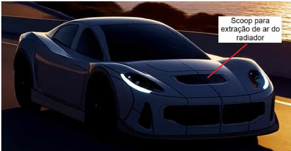
Fig 8 – Renderização 3D do Veículo DeCarbon mostrando o scoop de extração de ar quente do radiador, que otimiza o fluxo reduzindo o arraste aerodinâmico
