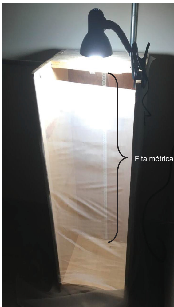
FIGURA 2 – TORRE DE VOO UTILIZADA PARA O BIOENSAIO DE DESLOCAMENTO VERTICAL (VOO E QUEDA LIVRE)
