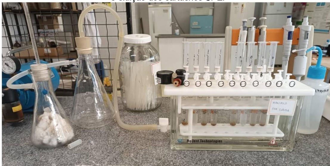
Figura 9: Sistema Manyfold para condicionamento, extração e eluição dos cartuchos SPE.
