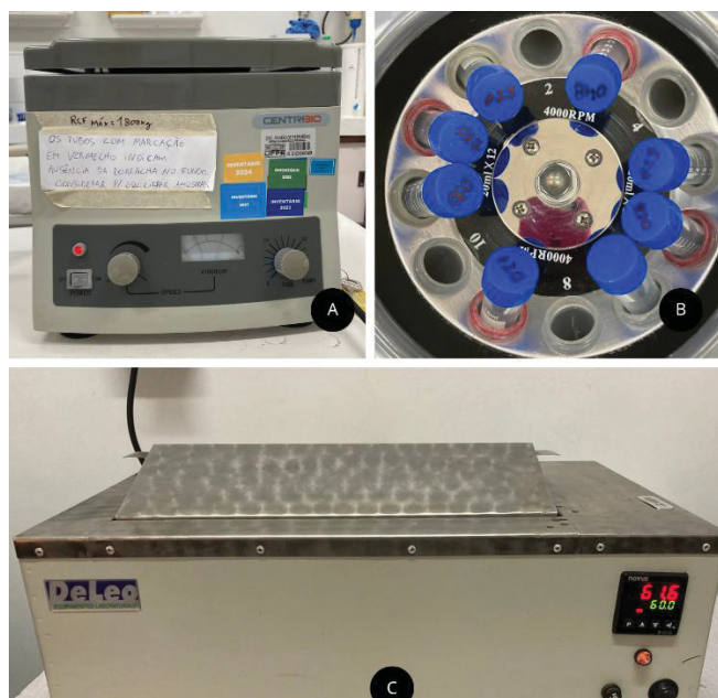
FIGURA 2 – (2A) Centrífuga para tubos Falcon; (2B) Vista interna da centrífuga com os tubos Falcon dispostos em equilíbrio; (2C) Banho-maria.
