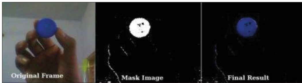
FIGURA 4 – EXEMPLO DE SEGMENTAÇÃO DA COR AZUL FEITA PELO OPENCV.
