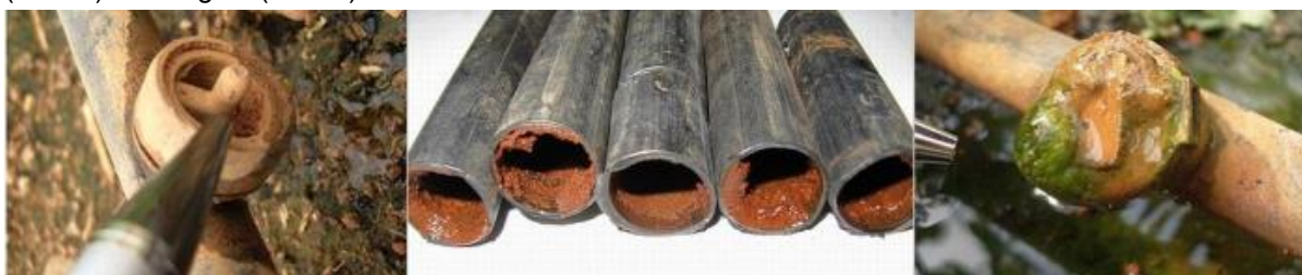
FIGURA 1 – ENTUPIENTOS NA IRRIGAÇÃO POR GOTEJAMENTO: físico (esquerda), químico (centro) e biológico (direita).
