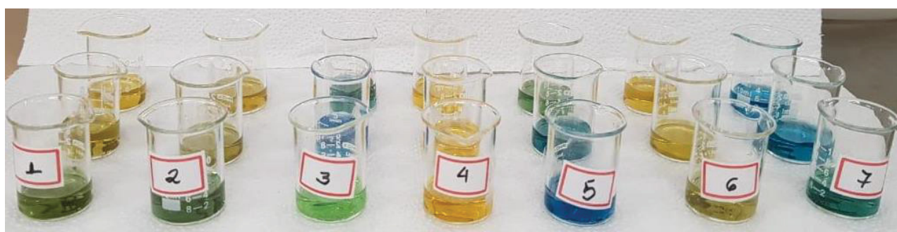
Figura 54. Resultado do teste da atividade dos compostos comerciais: (1) \text{NH}_4\text{VO}_3 , (2) \text{NaVO}_3 , (3) \text{V}_2\text{O}_5 , (4) \text{VO}(\text{acac})_2 , (5) \text{VOSO}_4 e (6) \text{V}_2\text{O}_4 . No béquer (7) está o produto II. As alíquotas foram basificadas com tampão de \text{NaH}_2\text{PO}_4/\text{Na}_2\text{HPO}_4 ( 200 \text{ mmol L}^{-1} ) em pH 8 após 1 min (frente), 5 min (centro) e 30 min (atrás). Os compostos foram adicionados ao meio de reação contendo o azul de timol ( 0,1 \text{ mmol L}^{-1} ), \text{KI} ( 3,0 \text{ mmol L}^{-1} ) e \text{H}_2\text{O}_2 ( 1,0 \text{ mmol L}^{-1} ), seguido do ajuste do pH para 8.
