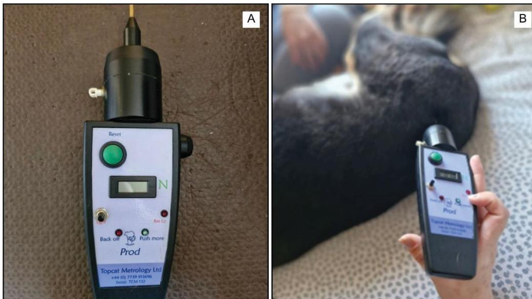
Figura 2. (A) Algômetro de pressão Topcat® com ponteira de 3 mm e força máxima de 25 N, utilizado para mensuração do limiar de dor mecânica em cães. (B) Aplicação do algômetro a 2 cm crâniodorsal ao trocânter maior na articulação coxofemoral de um cão, conforme protocolo descrito por Lascelles (2016). Fonte: própria autoria, 2025.
