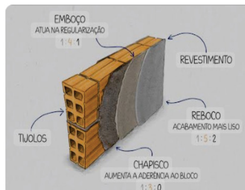
Figura 16 – Detalhe Alvenaria Convencional
