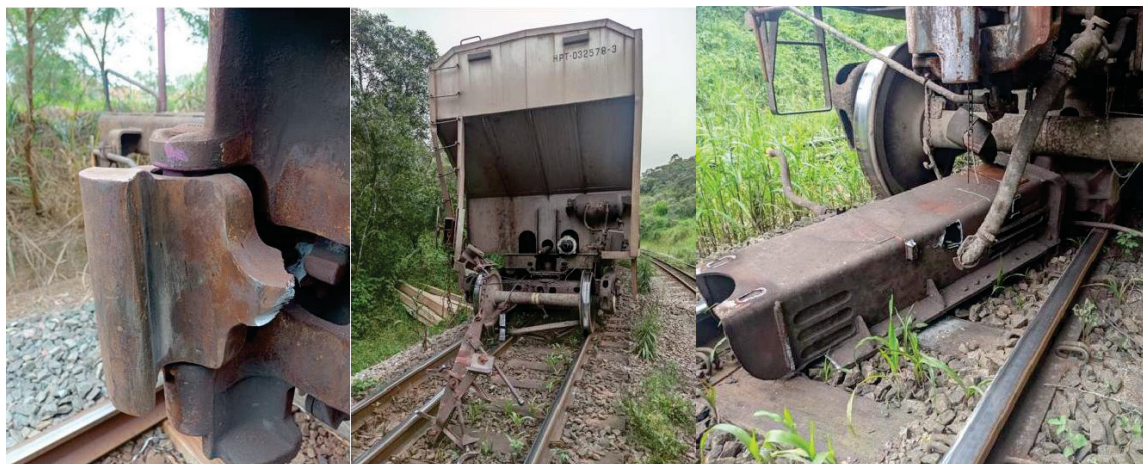
FIGURA 8 – Ocorrência de quebra de mandíbula e arrancamento de longarina.
