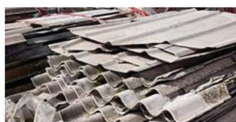
Telhas de amianto
