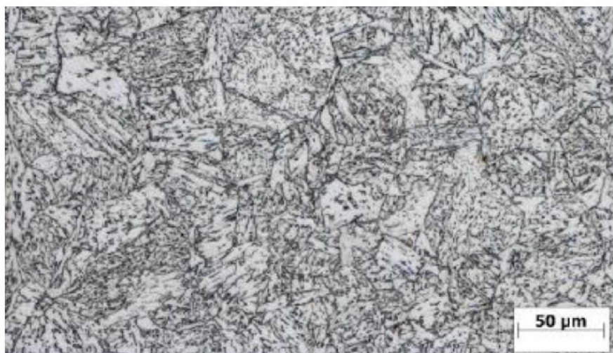
FIGURA 51 – MICROGRAFIA ZTA – AHSS700
