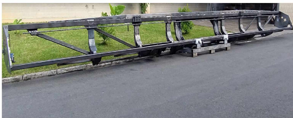
FIGURA 55 – CONJUNTO CHASSIS SOLDADO
