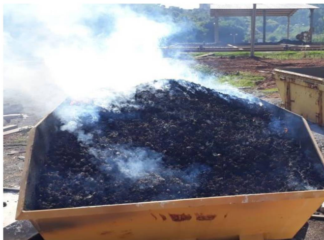
FIGURA 4 – LODO EM COMBUSTÃO SOB PROCESSO DE ESTABILIZAÇÃO ALCALINA
