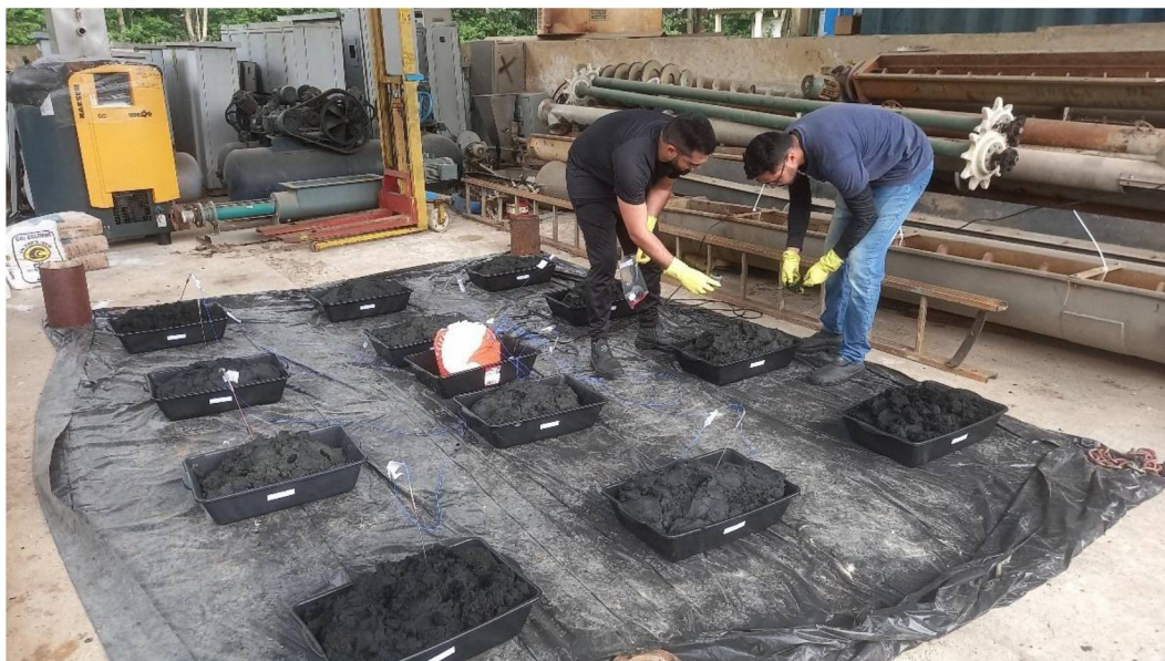
FIGURA 16 – DISPOSIÇÃO DAS UNIDADES EXPERIMENTAIS NA FASE 1 PARA AVALIAÇÃO FÍSICO-QUÍMICA E INSERÇÃO DOS TERMOPARES NAS PILHAS DE LODO NAS UNIDADES
