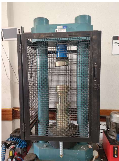
FIGURA 7 - PRENSA ELÉTRICA MODELO FT 01 DA MARCA FOREST COM CAPACIDADE DE 200 TONELADAS
