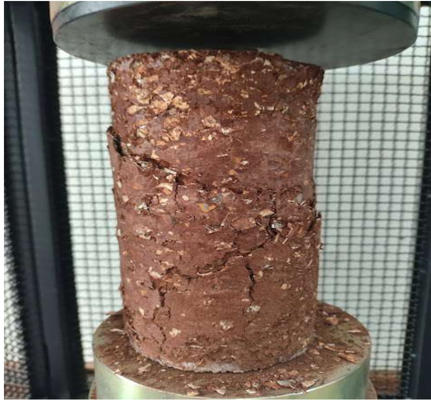
FIGURA 2 – ENSAIO DE COMPRESSÃO SIMPLES.
