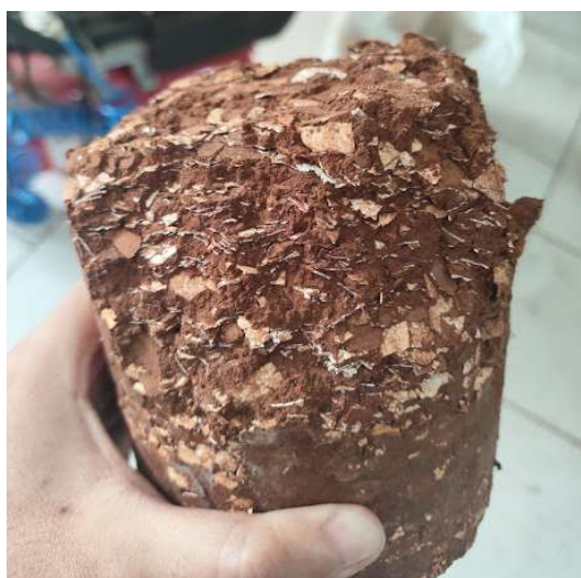
FIGURA 8 - CORPO DE PROVA DO TIJOLO ECOLÓGICO COM ADIÇÃO DE CASCA DE OVO ROMPIDO.
