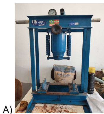
FIGURA 5 A e B – PRENSA HIDRÁULICA E CILINDRO DE PVC USADOS NO ESTUDO.
