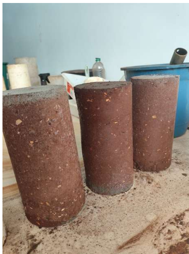
FIGURA 6 - TIJOLO SOLO CIMENTO COM 10% DE CASCA DE OVO
