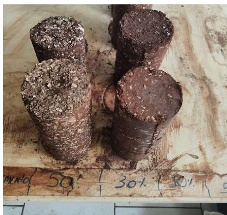
FIGURA 9 - TIJOLO SOLO CIMENTO COM 50% DE ADIÇÃO COMPARADO COM 30%.
