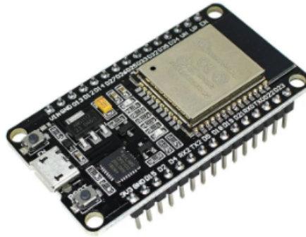
Figura 14: ESP32, utilizado como emulador Wi-Fi
