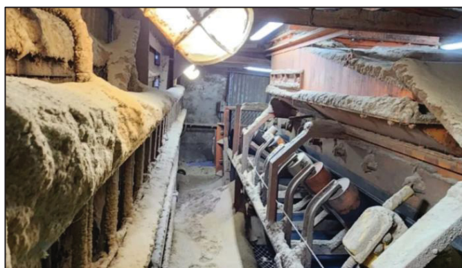
FIGURA 3 - Falta de manutenção e acúmulo de poeira em esteira do Terminal de Exportação do Corredor Leste – Porto de Paranaguá
