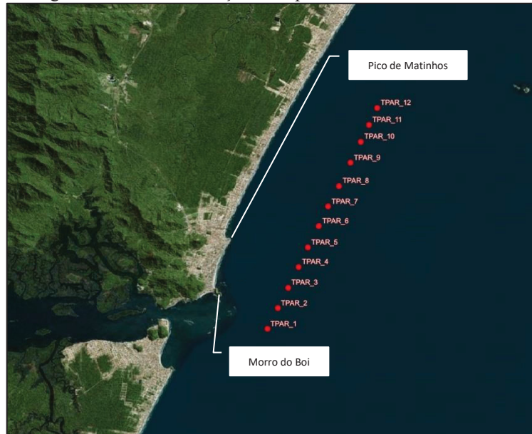
Figura 7: Pontos de inserção do espectro de ondas no contorno
