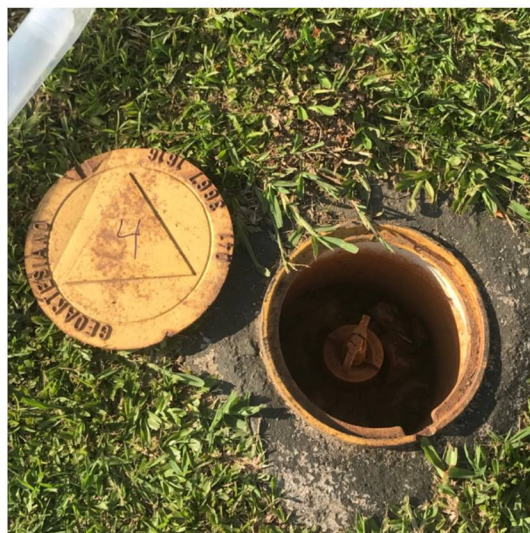
FIGURA 2 - ESTRUTURA DO POÇO DE MONITORAMENTO APÓS INSTALADO.
