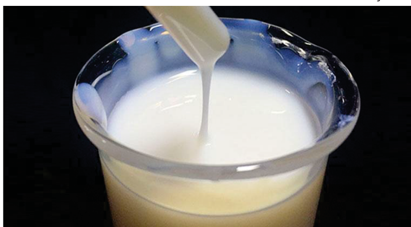
FIGURA 9 - MODELO DE EMULSÃO MATRIZ UTILIZADO EM MINERAÇÃO
