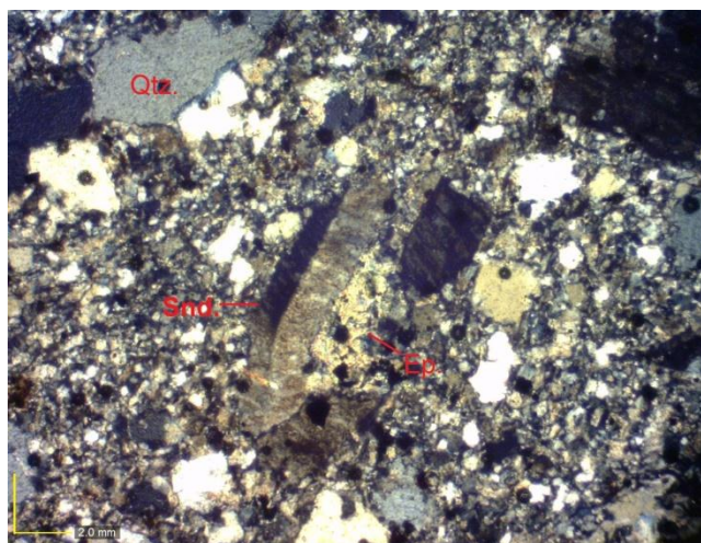
FIGURA 16 - Foto micrografia de amostra de riolito (457/14D) , destacando sanidina, epidoto e quartzo. Fonte: Rosin (2015).
