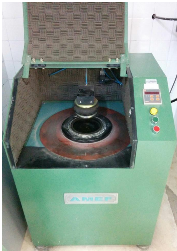
FIGURA 10 - Pulverizador utilizado para redução das amostras quarteadas.
