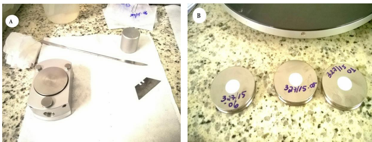
FIGURA 8 – A) Material para preparo das pastilhas prensadas. B) Pastilhas prensadas com amostras de dentes pulverizados.
