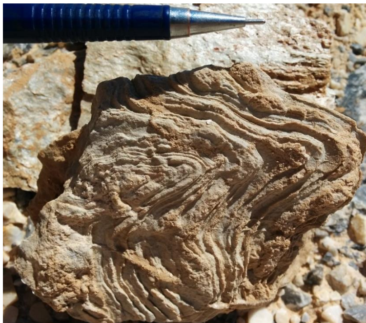
Figura 19 – Dobra milimétrica em amostra de mão de mármore dolomítico observada na frente de lavra do ponto 02, ocorrendo próximo ao plano de falha N65E/65NW.
