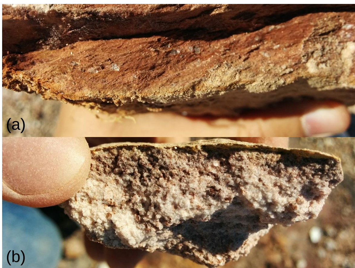
Figura 16 – (a) Quartzo-sericita filito castanho com cristais de até dois milímetros de quartzo orientados definindo a foliação S_1 , ponto 07. (b) Metarenito com cristais subarredondados e esféricos de quartzo de até um milímetro, orientados definindo a foliação S_1 , ponto 07.
