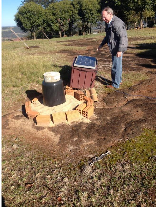
Figura 10 – Sismógrafo LDSAE que integra a rede local de monitoramento em Londrina.
