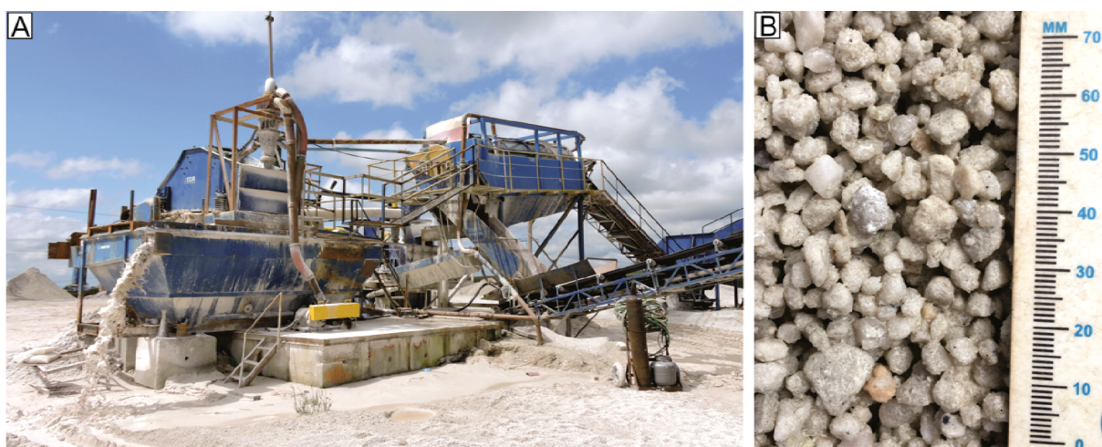
Figura 8: (A) Vista parcial da planta de beneficiamento com detalhe para o hidrociclone; (B) Detalhe de material selecionado que constitui exemplo de produto da mineração.
