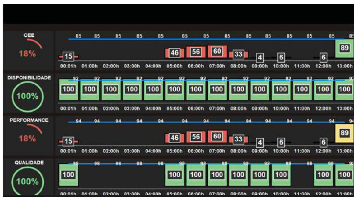
FIGURA 28 - Andon digital integrado ao sistema MES
