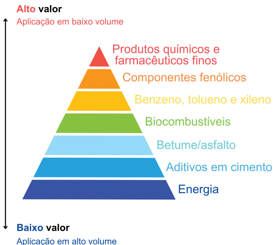
FIGURA 5 – REPRESENTAÇÃO ESQUEMÁTICA DAS APLICAÇÕES POTENCIAIS DA LIGNINA E VALORES RELATIVOS DE DIFERENTES CLASSES DE PRODUTOS
