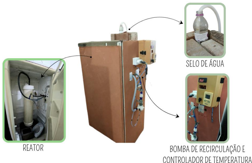
FIGURA 4 - REATOR DO INÓCULO
