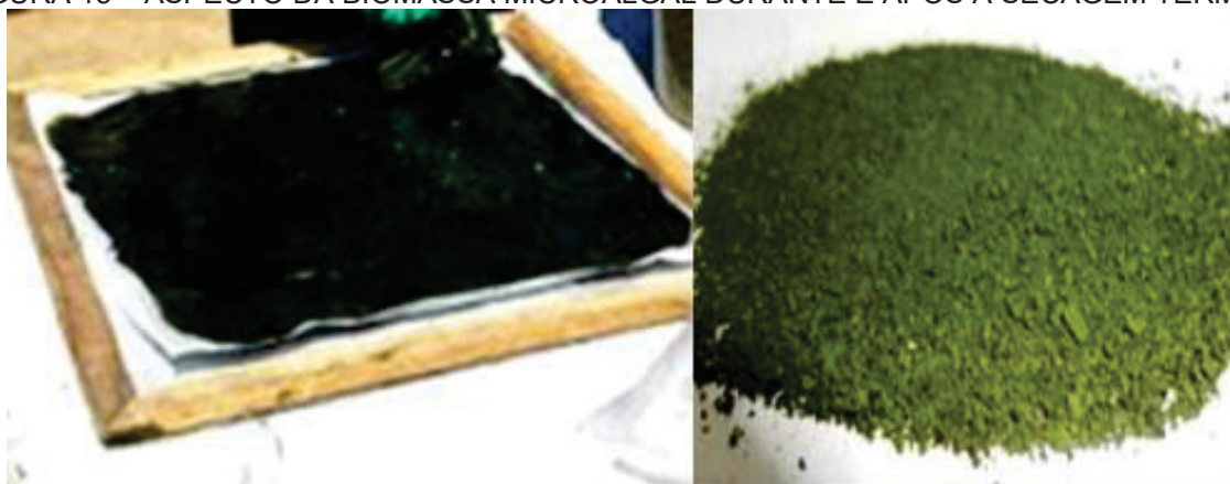
FIGURA 15 – ASPECTO DA BIOMASSA MICROALGAL DURANTE E APÓS A SECAGEM TÉRMICA
