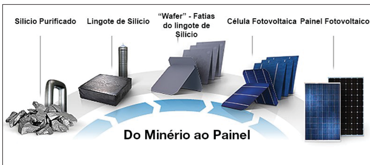
FIGURA 1 - PROCESSO PARA FABRICAÇÃO DO MÓDULO FOTOVOLTAICO
