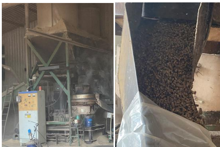
FIGURA 13: MATRIZ PELETIZADORA DA HMBIO
