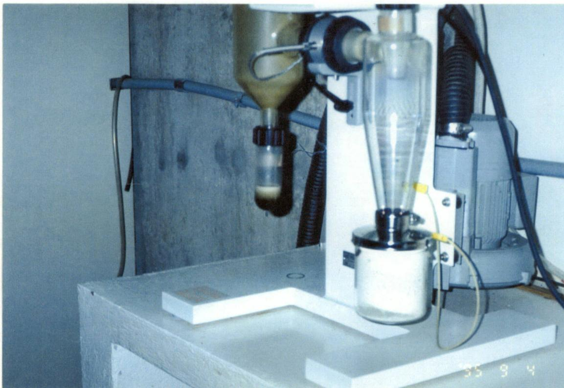
**Figura 41** - Mucilagem do parênquima desidratada em "Spray dryer", após ser concentrada em osmose reversa.
