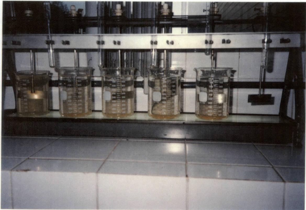
**Figura 39** - A foto acima mostra um teste de jarras realizado com o polissacarídeo retido em membrana de 100 kD. Em todos os bequeres foram adicionados 30 ppm de sulfato de alumínio. No bequer da esquerda não foi adicionado polieletrólito. Nos demais bequeres além do sulfato foi adicionado (da esquerda para a direita) : 0,2 ppm, 0,4 ppm, 0,6 ppm e 0,8 ppm de polieletrólito.
