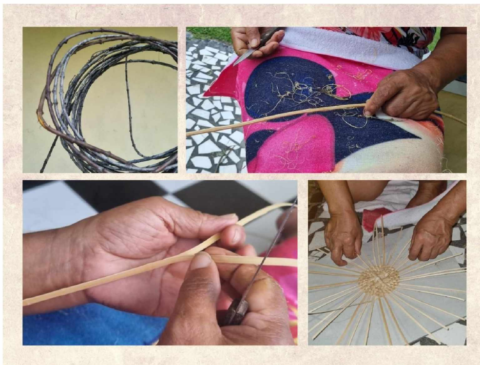
IMAGEM 1 – PRIMEIRAS ETAPAS: O CIPÓ EM SUA FORMA NATURAL, RASPAGEM DO CIPÓ, RACHADA AO MEIO, CORTE DAS “PERNAS” E INÍCIO DO TRANÇADO
