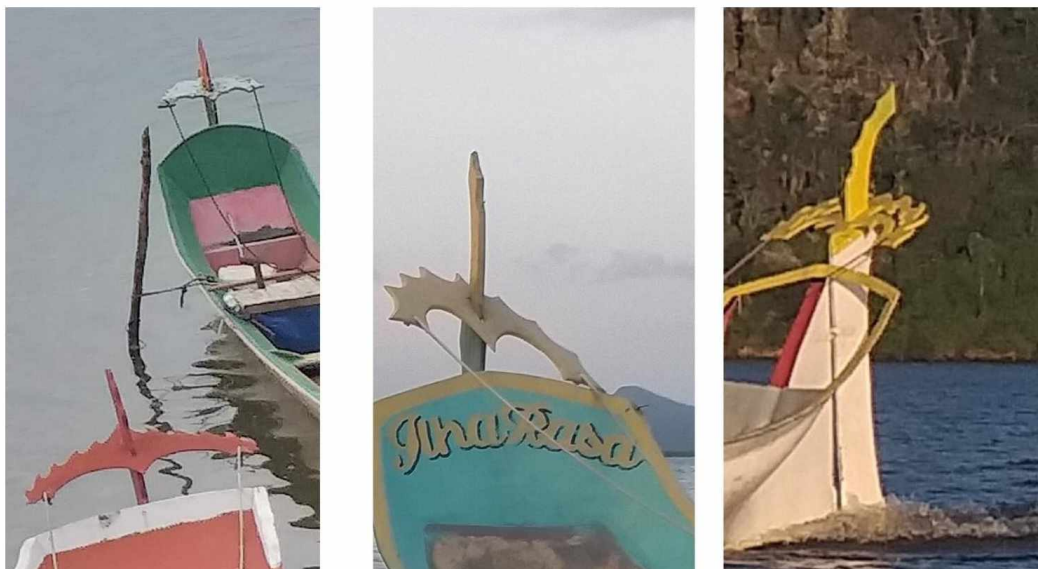
IMAGEM 30 – MEIAS-LUAS MODIFICADAS, PARTES QUE COMPÕEM O LEME DO BARCO
