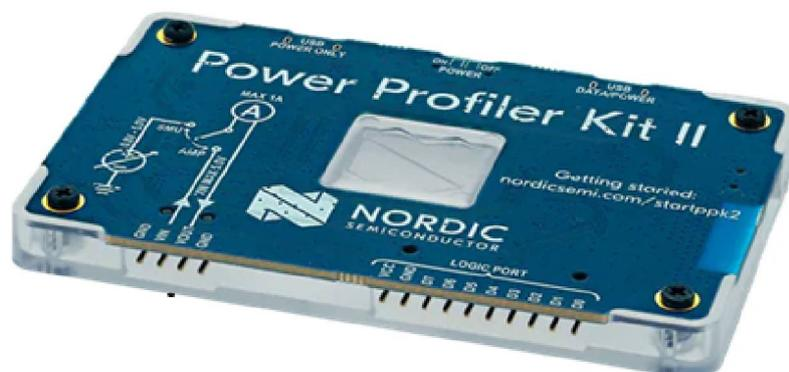
Figura 45 – Analisador de consumo de energia *Power Profiler Kit II* (ELECTRONICS, 2024).
