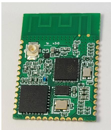
Figura 28 – Módulo final desenvolvido, destacando o microcontrolador e a antena integrada (O Autor, 2024)
