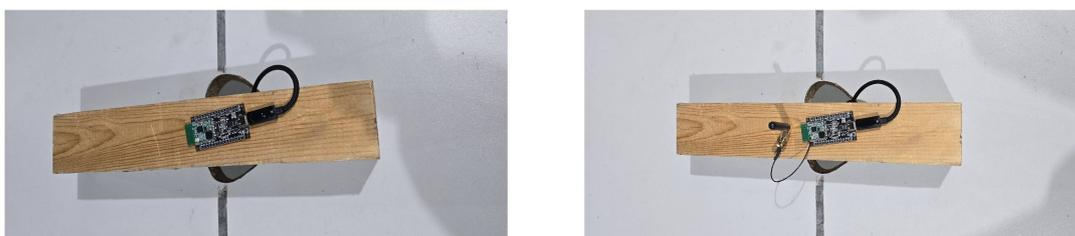
Figura 35 – (a) Antena PiFA integrada para WiFi e BLE; (b) Antena externa conectada ao rádio LoRa SX1276 (O Autor, 2024).
