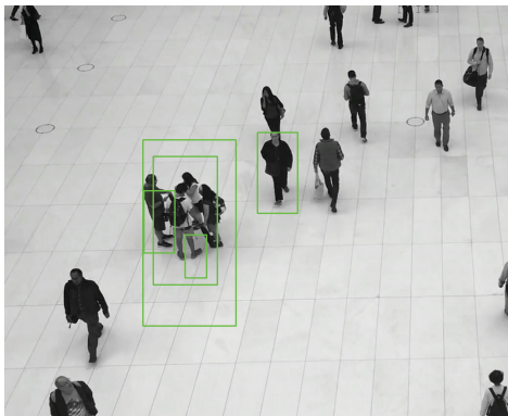
Figura 13. Exemplo de identificação em frame do VD3: Modelo Haar Cascade Fonte: O autor (2025)
