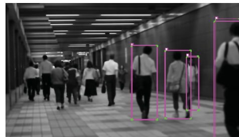
Figura 14. Exemplo de identificação em frame do VD4: Modelo Yolo v8 Fonte: O autor (2025)
